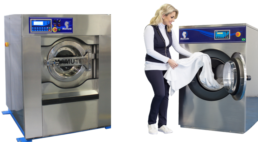
Modelo High Spin, com suspensão, fator G 300 Modelo Low Spin, fixo Modelo Industrial, as roupas entram e saem pela mesma porta.
