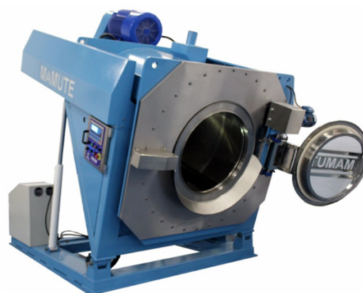
Lavadora em posição de descarga
